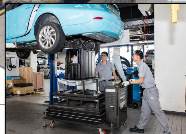
Remoção da bateria Movimentação da bateria e agregados Trabalho sob o veículo
